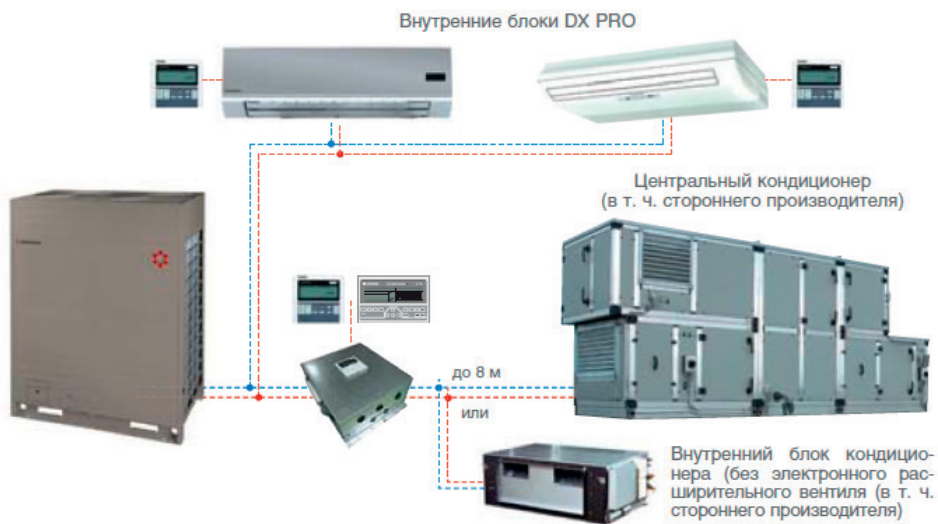
Рис. 1. Комплект для соединения с центральным кондиционером (АНУ)
